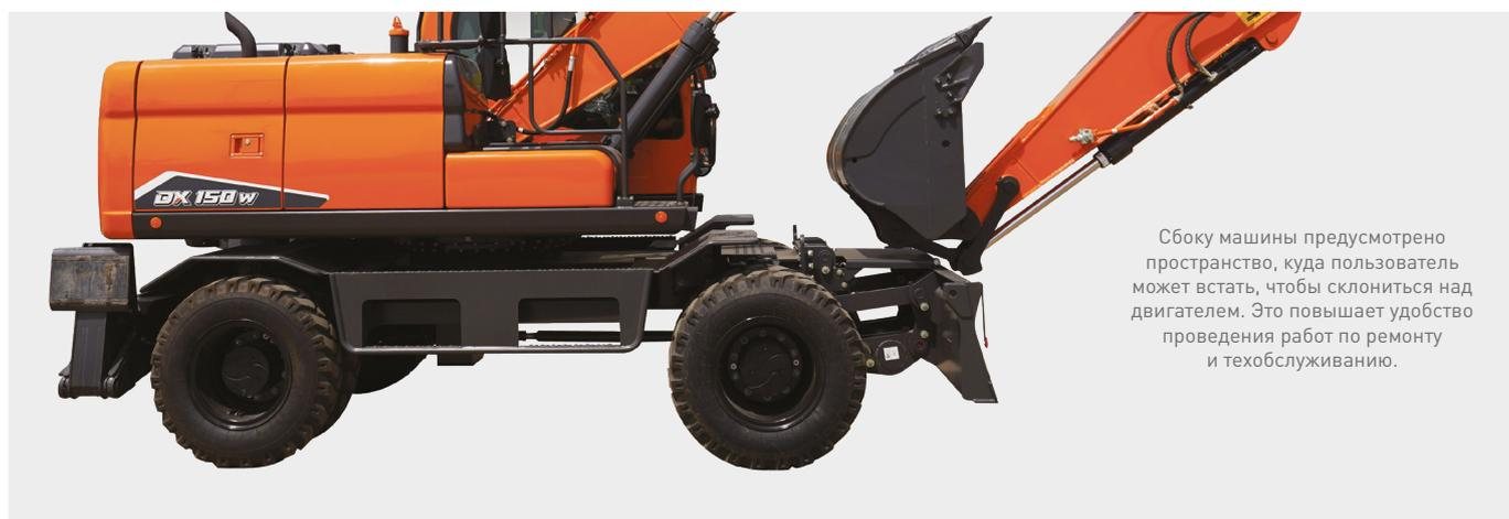
Сбоку машины предусмотрено пространство, куда пользователь может встать, чтобы склониться над двигателем. Это повышает удобство проведения работ по ремонту и техобслуживанию.
