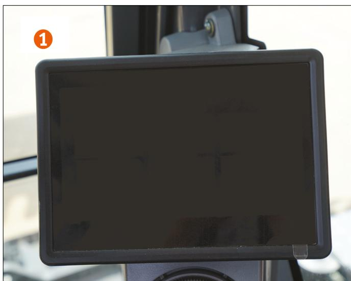
**БЛАГОДАРЯ УСТАНОВКЕ 8-ДЮЙМОВОГО МОНИТОРА ОПЕРАТОР ТЕПЕРЬ МОЖЕТ ЛЕГКО ПРОСМАТРИВАТЬ ИНФОРМАЦИЮ О РАБОТЕ ОБОРУДОВАНИЯ, ЧТО ЗНАЧИТЕЛЬНО ПОВЫШАЕТ УДОБСТВО УПРАВЛЕНИЯ МАШИНОЙ.**
